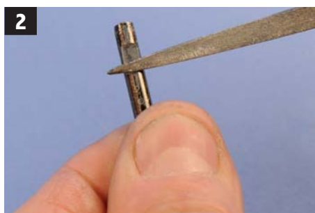
2 Faire des méplats sur la CAP des jambes de train 141AS4060. Make a key area with a file on music wire adapter.
