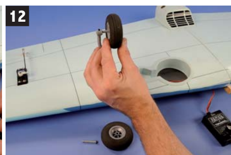
12 Passer la roue dans l'axe, circlip côté extérieur... Slip the wheel on the axle with the circlip pointing away from the strut...
