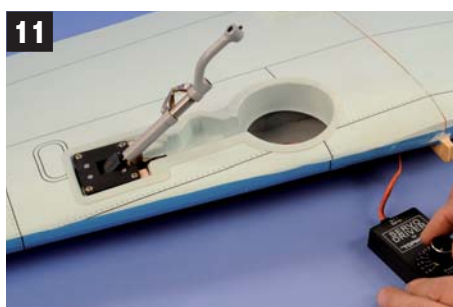
11 Ressortir le train avec le SERVO DRIVER. Extend retract with the SERVO DRIVER.
