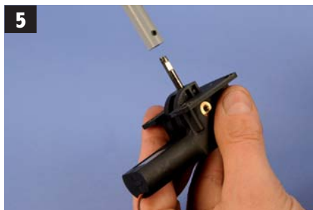
5 Présenter le fût sur la CAP.. Fit the strut on the adapter...
