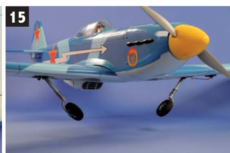
15 Faire plusieurs séquences sortie-rentree. Ajuster les réglages, si nécessaire. Perform several sequences UP-DOWN to see if all is fine. Adjust if necessary.
