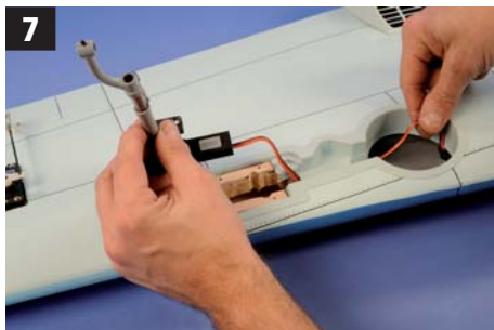
7 Passer le cordon d'alimentation du train dans l'aile... Route the retract power cord through the wing...
