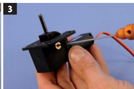
3 Visser la CAP dans le train... Fix the adapter in the retract...
