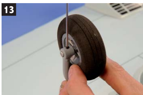
13 ...puis visser l'axe dans le train (utilisez chaque fois du frein filet style LOCTITE) ...then attach the axle to the gear and tighten the locking bolt (use LOCTITE threadlocker on every bolt)
